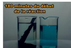
Pour le système (S), l'apparition de dépôt de cuivre et l'atténuation de la couleur de la solution prouve que le système a évolué selon la réaction :
