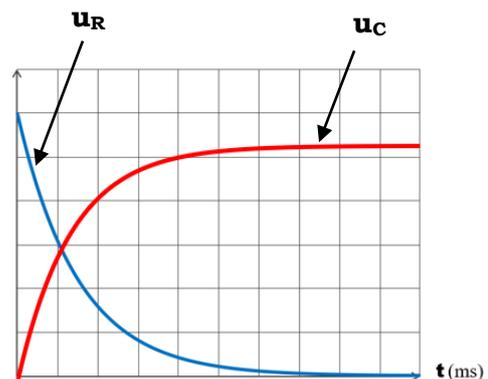
On remarque que lorsque la tension  $u_C$  atteint sa valeur maximale, la tension aux bornes du résistor  $u_R$  atteint sa valeur nulle. Par conséquent, l'intensité s'annule à la fin de la charge (Le condensateur se comporte comme un interrupteur ouvert).
